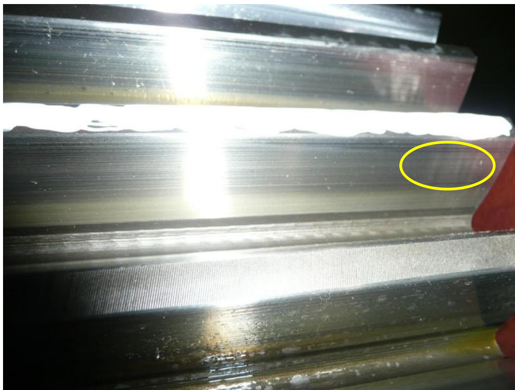
Imagem 3: Região da retirada da impressão do flanco do dente antes da aplicação REWITEC®
